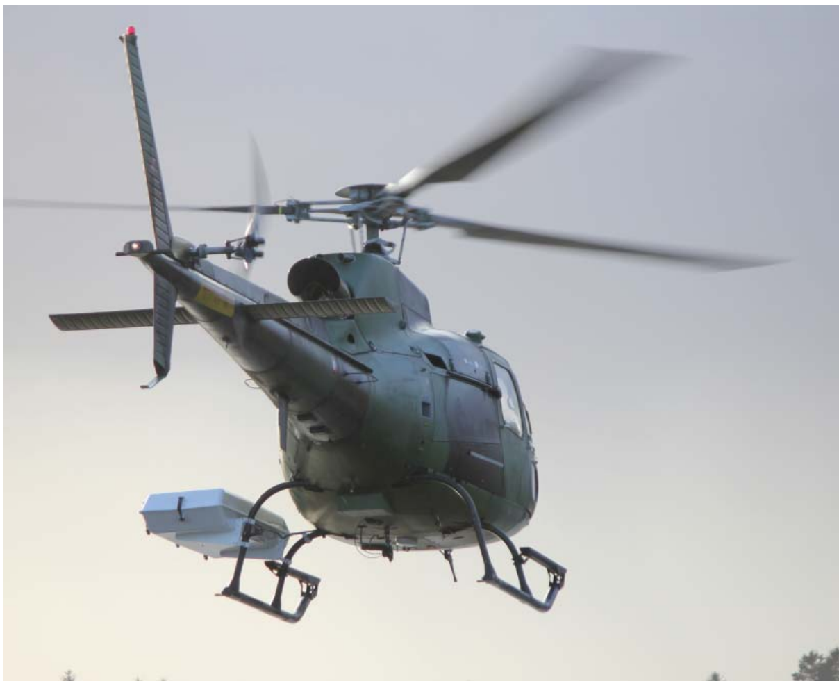
Træning i brug af luftbårent udstyr til måling af radioaktivitet påsat en af forsvarets Fennec helikoptere.
