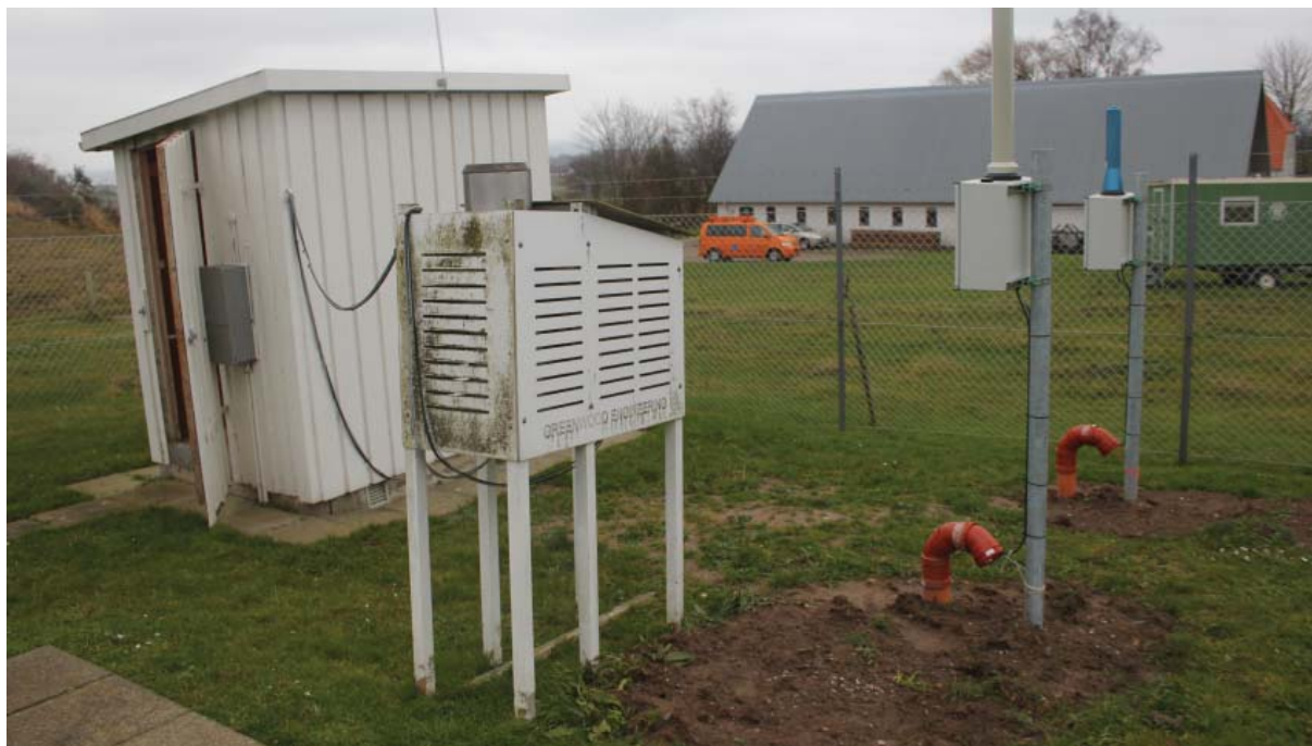
Beredskabsstyrelsens nye nukleare målestationer består af to enheder: En spektralmåler, der kan måle både spektrum og dosis, samt en stand-alone dosismåler, der fungerer som support og backup. Herudover ses en målehytte samt en ældre spektral-målestation. Den gamle spektral-målestation er under udfasning, men kører indtil den afsluttende test af den nye stationstype er færdiggjort.
