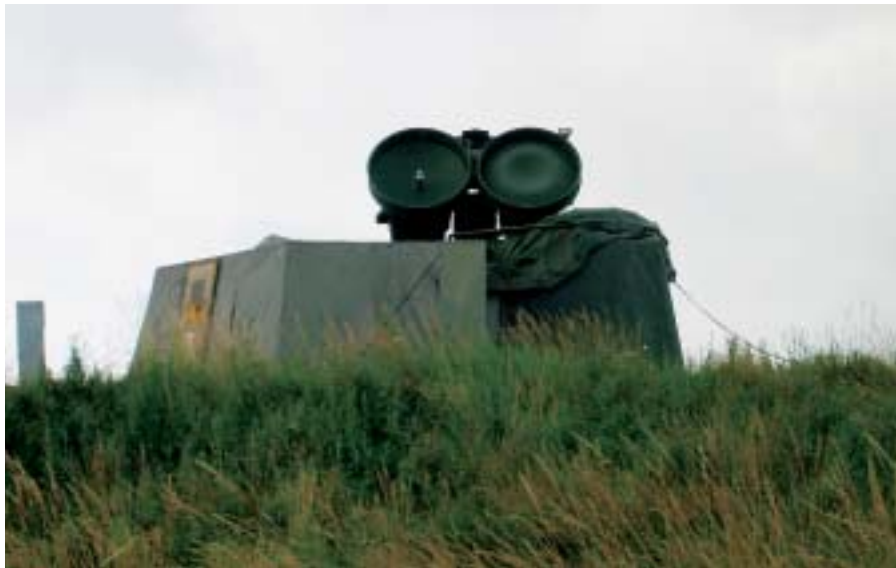
High Powered Illuminator Radar som bruges til at følge et luftmål. (Billede: Christian Pejstrup).
